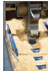
Compuerta deslizante para cerrar la caída de los platos individualmente
